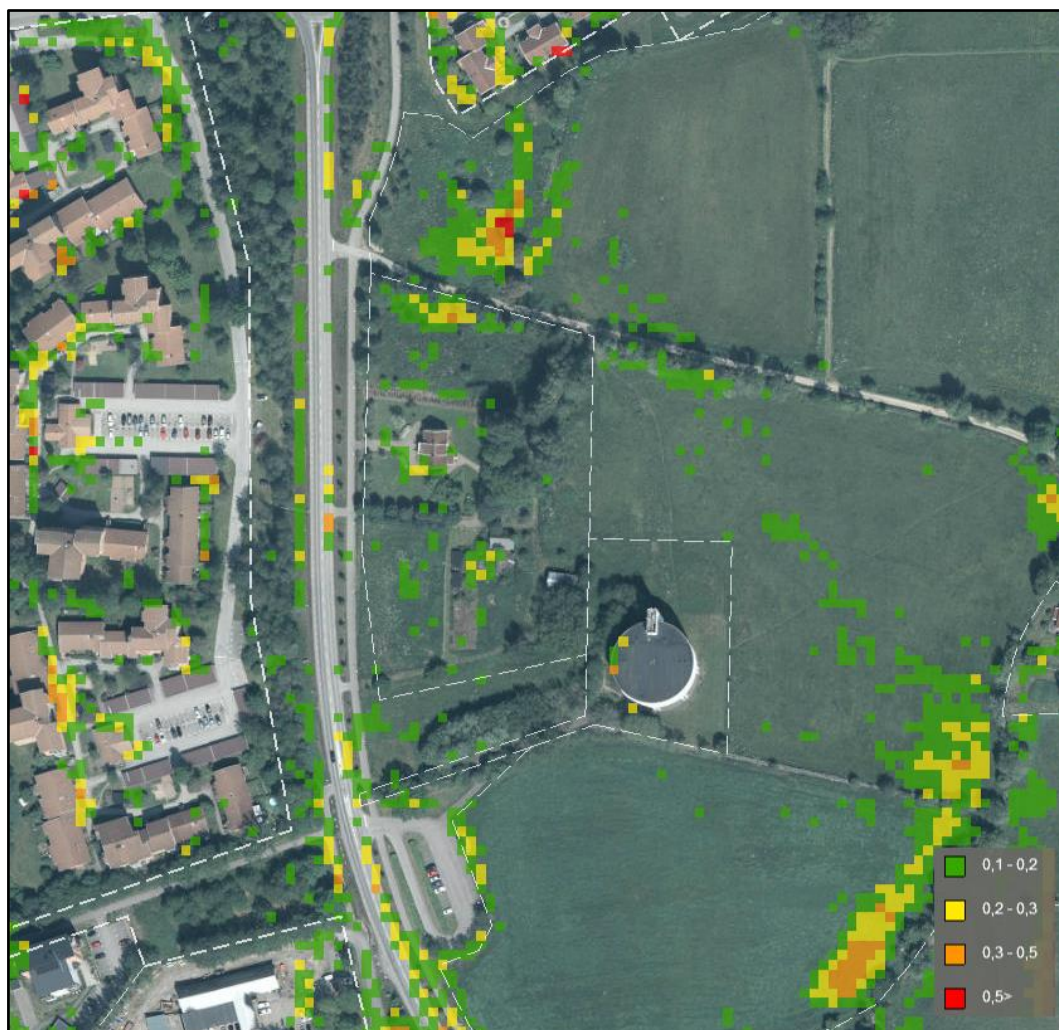
Figur 7. Maxnivåerna vid ett 300-årsregn i en skyfallskartering utförd av DHI 2015 på uppdrag av Växjö kommun. Nivåerna anges i meter.
