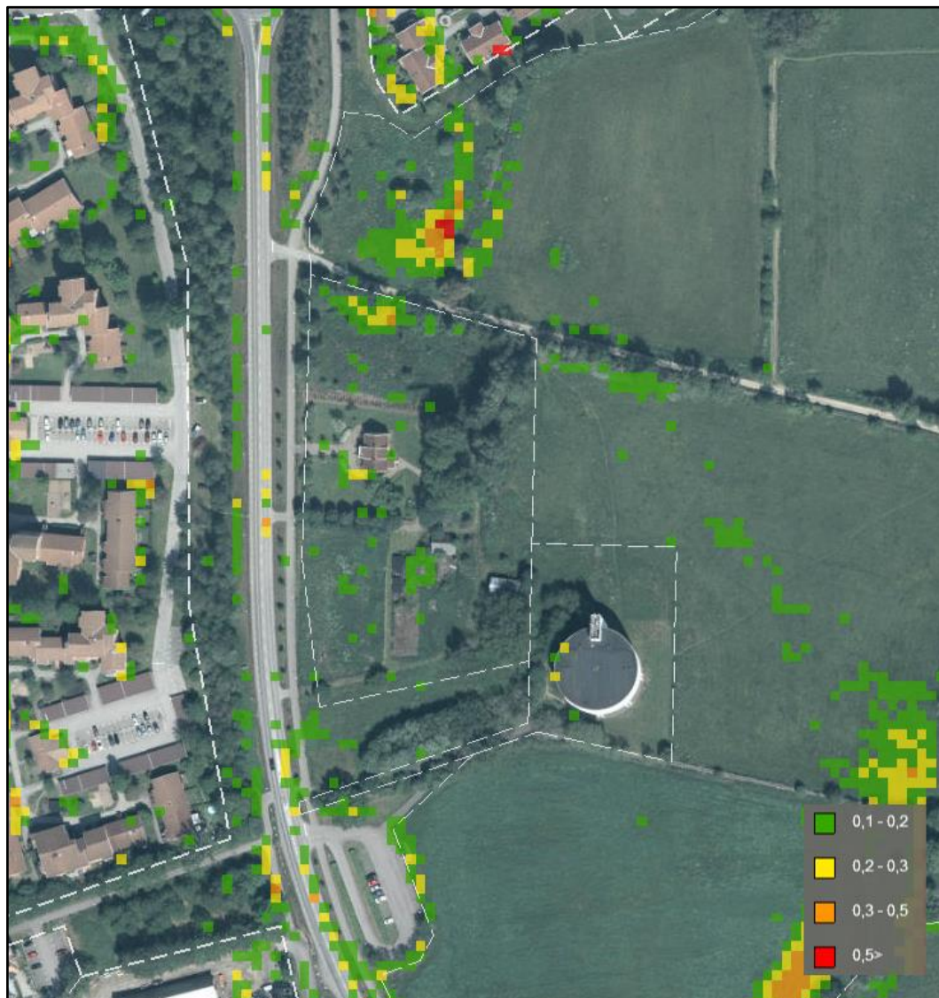
Figur 6. Maxnivåerna vid ett 100-årsregn i en skyfallskartering utförd av DHI 2015 på uppdrag av Växjö kommun. Nivåerna anges i meter.
