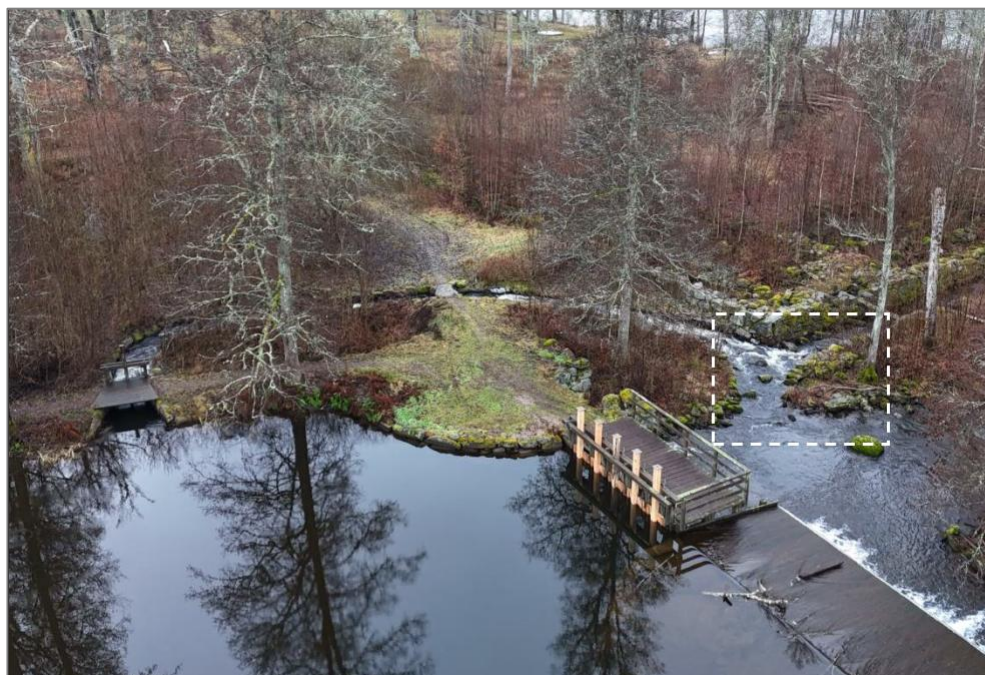
Figur 23. Drönbild omlöp. Vit ruta markerar område vid omlöpets nedre del, det vill säga ingången vid uppströms vandring. Foto: (Tyréns Sverige AB, 2024)
