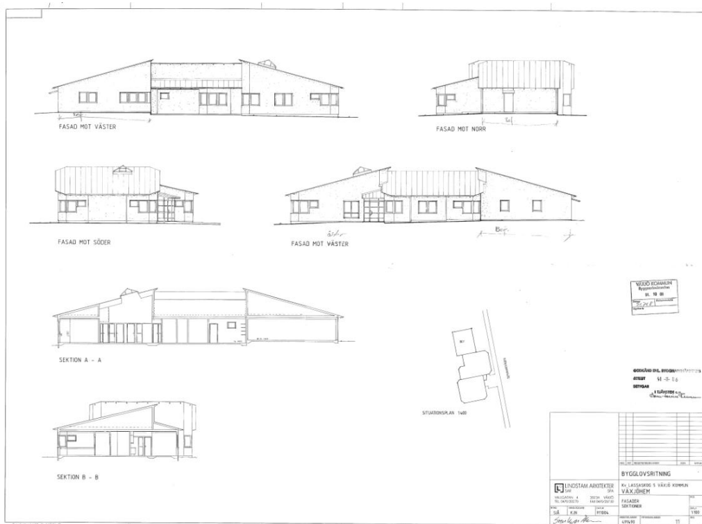
Figur 30 Bygglövsritning godkänd 1991-11-09 för om och tillbyggnad av kvarterslokal. Notera den postmoderna stilen med vinklade hörn, flera takvinklar samt de olika fönsterbröstningarna. Källa: Växjö kommun.
