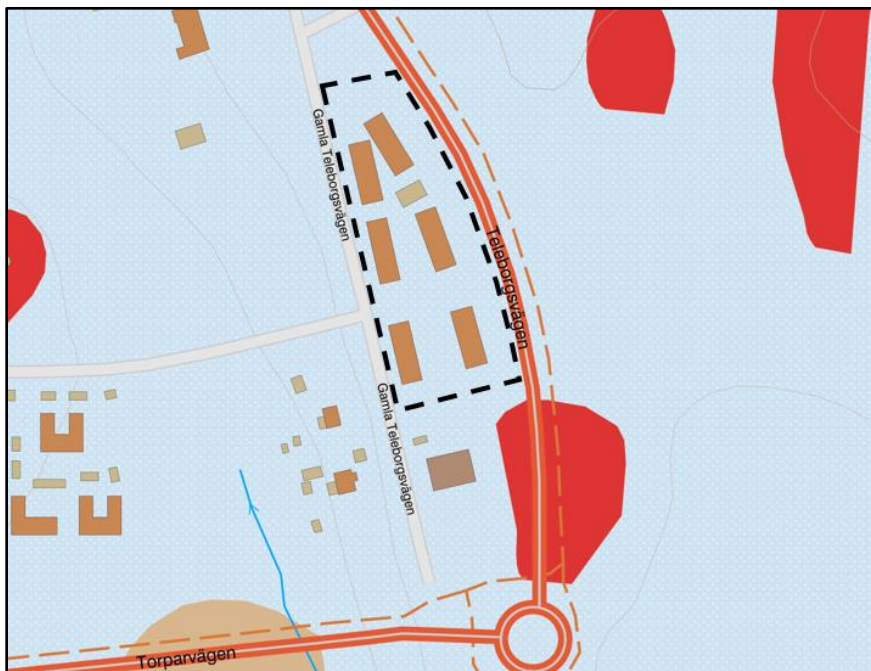
Figur 3. Jordartskarta från SGU (1990). Blått prickigt raster representeras av sandig morän, rött raster representeras av berg eller berg i dagen. Svart linje visar ungefärlig planområdesgräns.
