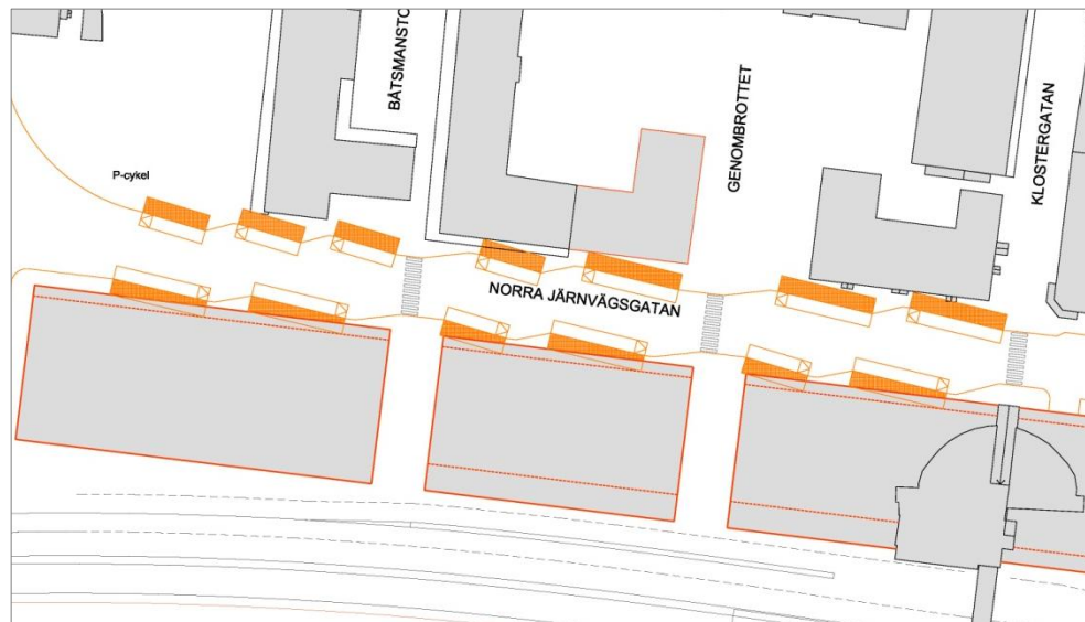
Figur 4-6. Sågtandsuppställning, alternativ lösning. Finns även som bilaga 4 i skala 1:500
