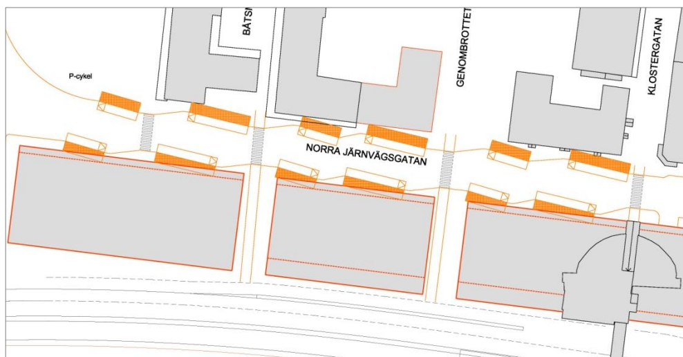
Figur 4-5. Sågtandsuppställning. Finns även som bilaga 3 i skala 1:500
