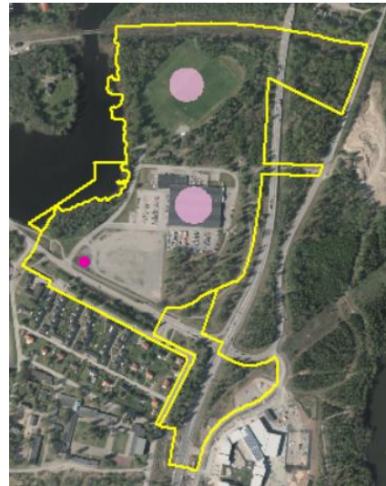
Karta över registrerad MIFO-punkt (mörkt rosa) inom planområdets sydvästra del i anslutning till Solångsvägens infart. Befintlig byggnad inom fastigheten Rimfrosten 1 och den tidigare motorbanan på fastigheten Råppe 7:3 är markerade (ljus rosa) då markförorening kan förekomma.
