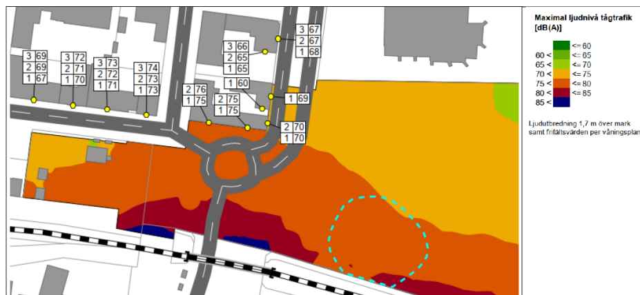
Figur 8. Linnérondellen i befintligt läge. Maximal ljudnivå från tågtrafik. (Utdrag från bilaga 3)
