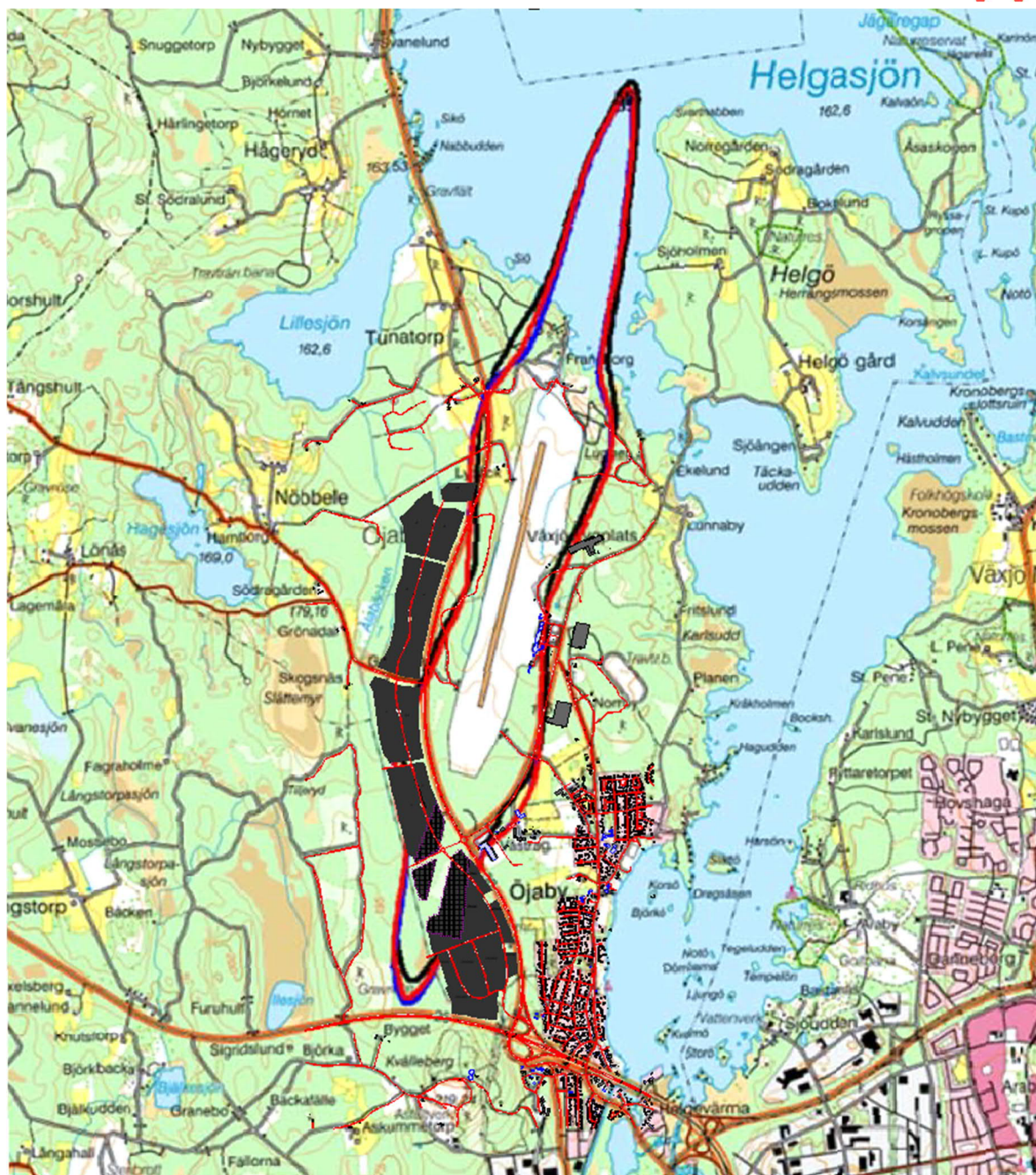
Figur 8 Utbredning för yta med FBN överskridande 55 dBA enligt tidigare utförd flygbullerutredning.
