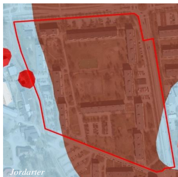
Det bruna området består av kär, i det ljusblå områdena finns morän och de röda fläckarna visar på berg i dagen.
